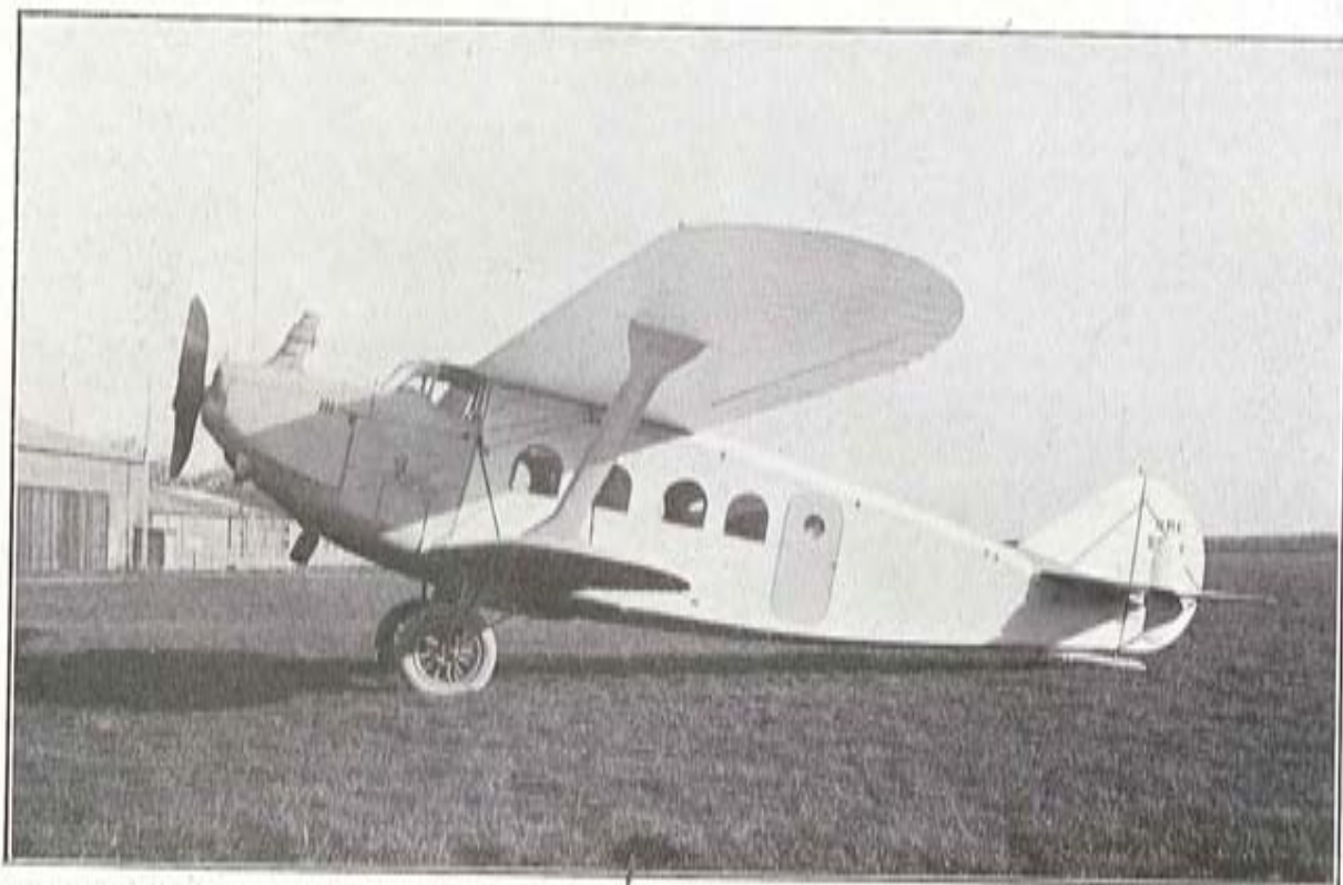
L'avion limousine de transport commercial Breguet 280 T. Vue latérale d'ensemble (avec le moteur Renault 500 cv. démultiplié).
